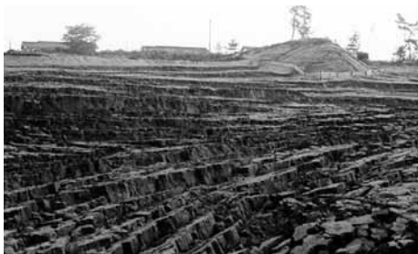
写真1 砂丘の裾野で発生した流動被害(竹内寛氏撮影)
