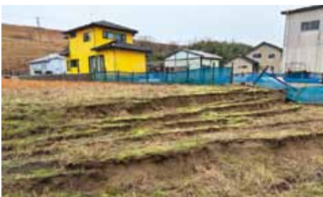
写真2 内灘砂丘で見られた流動被害(2024年能登半島地震)
