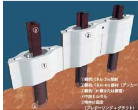
図1 親杭パネル壁工法概要図
