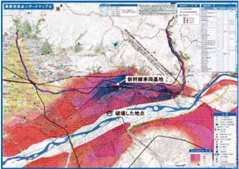
図16 千曲川水害の浸水区域とハザードマップの比較（文献5）
