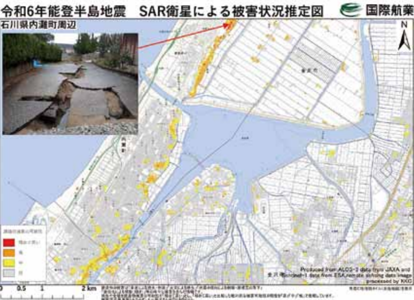
図2 内灘町の液状化被害状況
