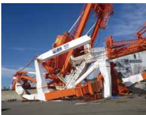
写真10 写真11 強風により倒壊したガントリークレーン
