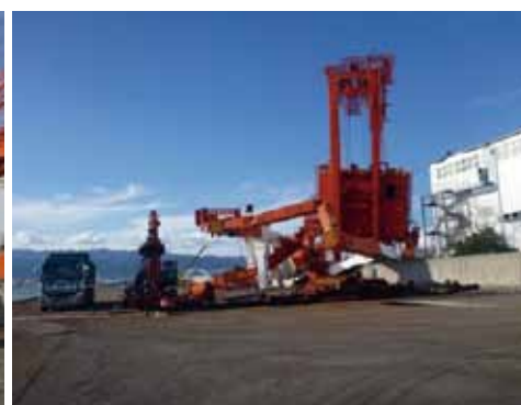
写真10 写真11 強風により倒壊したガントリークレーン
