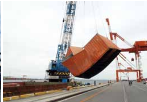
写真13 写真14 水没コンテナ回収状況
