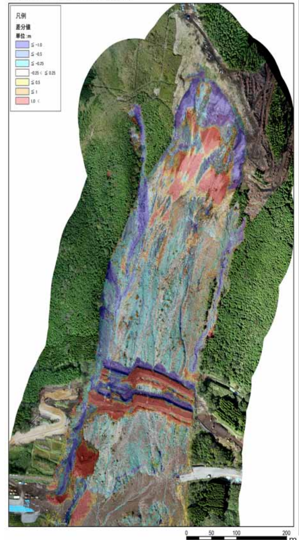
図-2 ドローンを用いて継続的に計測した斜面の変化状況（差分解析図）
