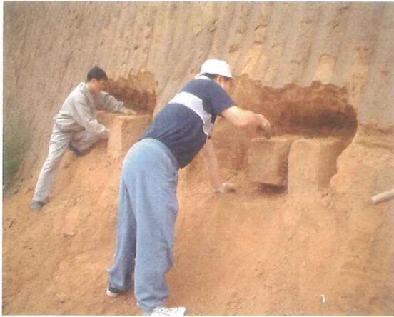
図3 西安市における黄土のサンプリング
