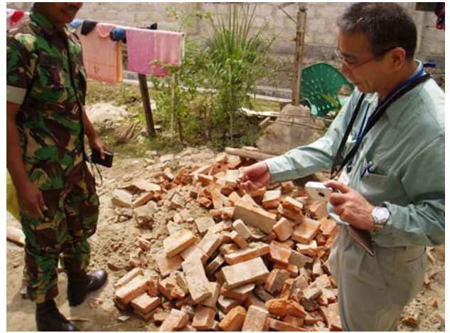
写真-40, 写真-41 グヌンシトリの軍宿舎：悪品質の材料の使用と施工不良
