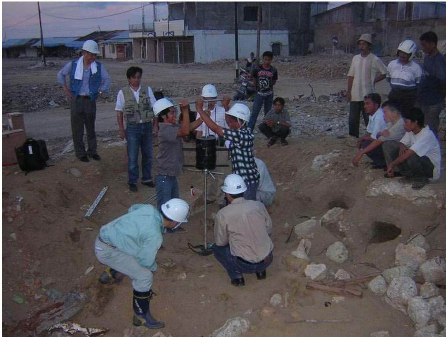
暗くなるまで実施したニアス島グヌンシトリの液状化被害地域でのスウェーデン式サウンディングの現地講習 (周辺建物は撤去され更地になっている)
