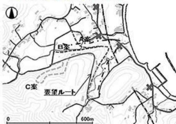
図1 県道寸断箇所と迂回路検討ルート
