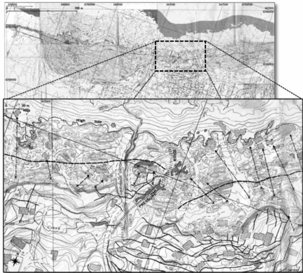
図2 アメリカ地質調査所による1964年アラスカ地震報告書に畳み込まれたアンカレッジ市ターナゲンハイツの地すべり地図の一部拡大
