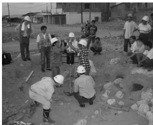
写真-1 暗くなるまで実施したニアス島グヌンシトリ市内の液状化被害地域でのスウェーデン式サウンディングの実地講習(周辺建物は撤去され更地になっている)
