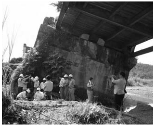
写真-2 傾斜した被害を受けたままのイダノ・ガオ橋でのスウェーデン式サウンディングの実地講習
